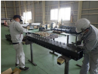
写真 3. 普通ボルト締結状況
